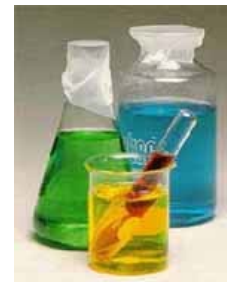
รูปที่ 2.5 การใช้แผ่นพาราฟิล์มปิดฝาภาชนะ
